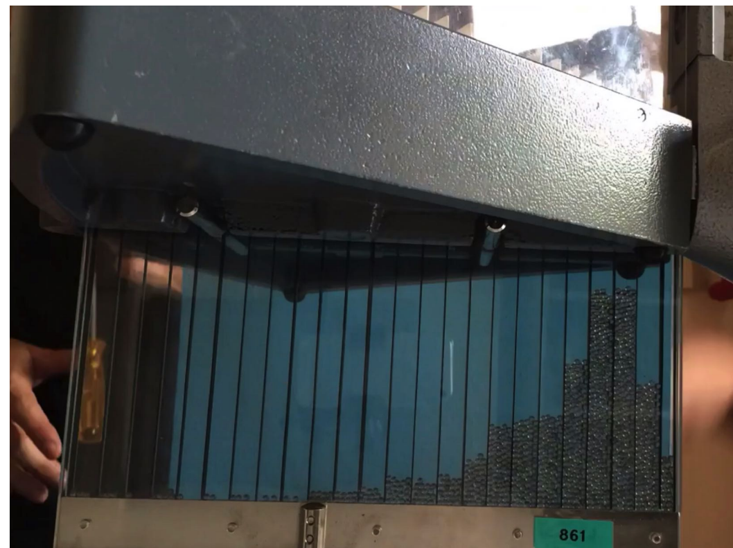
Zeitraffer-Aufnahme mit mobilen Endgeräten der Geschwindigkeitsverteilung von Glaskugeln als Modellgas im Demonstrationspraktikum Physik, FB Physik
