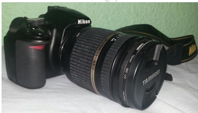
Abbildung 17: Spiegelreflexkamera; der Autofokus wird durch einen piezoelektrisch arbeitenden Ultraschallmotor angetrieben
