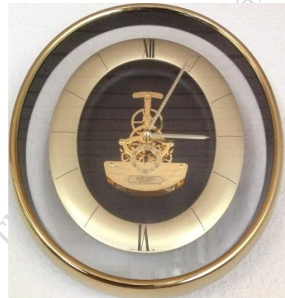
Abbildung 16: Quarzuhr; der Taktgeber besteht aus einem schwingenden Quarzkristall
