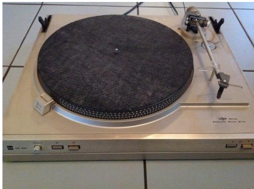
Abbildung 15: Plattenspieler; Tonabnehmer können piezoelektrisch arbeiten
