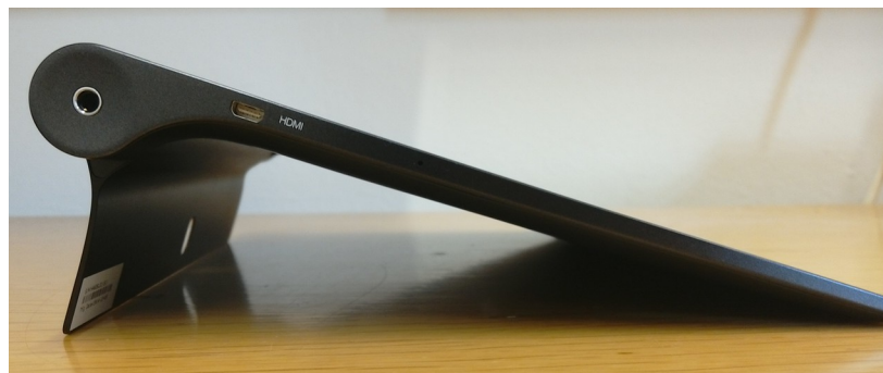
Abbildung 24: Lenovo Yoga 2-1051F, rechte Seitenansicht, von links nach rechts: 3,5mm Klinke, micro-HDMI
