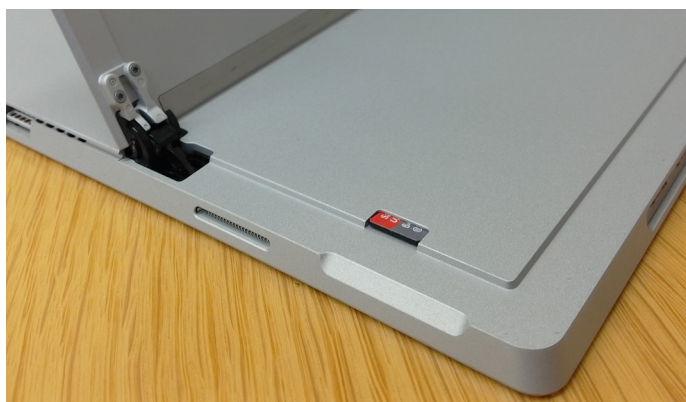
Abbildung 79: Microsoft Surface 3 Pro, Die SD-Karte (grau-rot) befindet sich zwar hinter dem Standfuß, wird aber nicht weiter gesichert.
