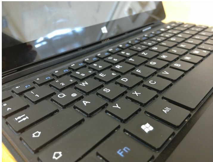
Abbildung 40: Tastatur des Trekstore SurfTab Wintron 10.1 ST10432-3 man beachte die Verbindung unterhalb des Windows-Logos am Gerät
