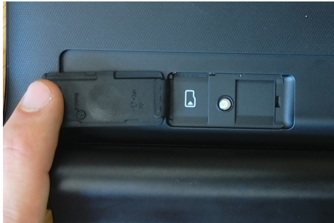
Abbildung 80: Lenovo Yoga 2-851F, Die SD-Karte kann sicher hinter dem Standfuß unter einer extra Klappe eingesetzt werden.
