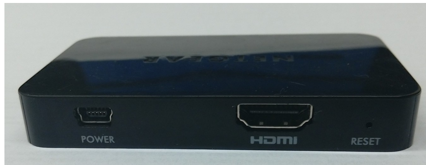
Abbildung 57: Netgear-Push2TV-PTV 3000 von links nach rechts: mini-USB, HDMI, Reset
