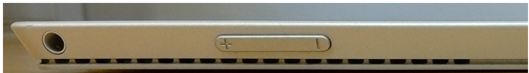
Abbildung 28: Microsoft Surface 3 Pro, linke Seitenansicht von links nach rechts: 3,5 mm Klinke, Lautstärkewippe
