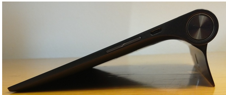
Abbildung 20: Lenovo Yoga 2-851F, linke Seitenansicht, von links nach rechts: Lautstärkewippe, micro-USB, Power-Button
