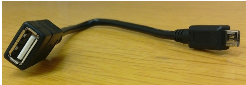
Abbildung 48: Standard Verbindungskabel, USB links, micro-USB rechts
