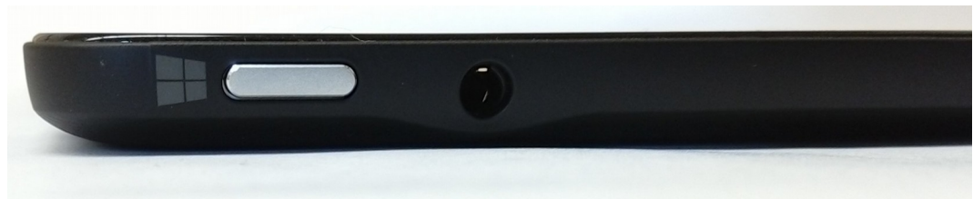
Abbildung 9: Dell Venue 8 Pro 5830-T01D Oberseite, von links nach rechts: Windows-Taste, 3,5mm Klinke
