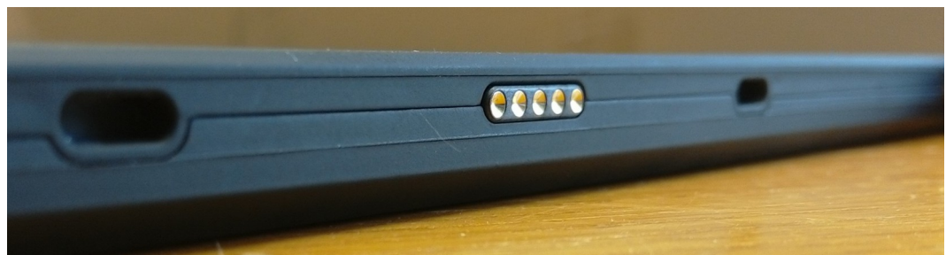
Abbildung 37: Tastaturanschlüsse beim Trekstore Surftab Wintron 10.1 ST10432-3, fünf Kontakte in der Mitte des Bildes, rechts und links Vertiefungen zur Befestigung an Tastatur
