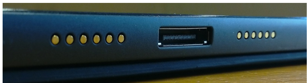
Abbildung 38: Tastaturanschluss Dell Venue 11 Pro 7140-T07G rechts und links jeweils 6 Kontakte, Mitte Dockingport
