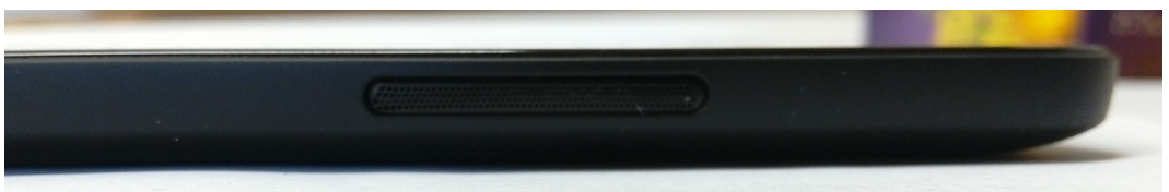
Abbildung 10: Dell Venue 8 Pro 5830-T01D Unterseite: Lautsprecher
