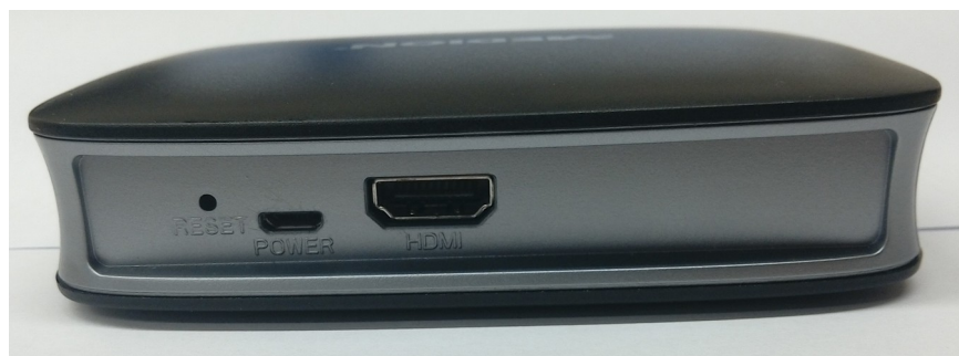
Abbildung 56: Medion-Zoombox 90233.03 von links nach rechts: Reset, micro-USB, HDMI
