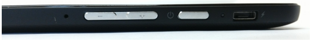
Abbildung 8: Dell Venue 8 Pro 5830-T01D rechte Seite, von links nach rechts: Mikrofon Lautstärkewippe Power-Button, mini-USB
