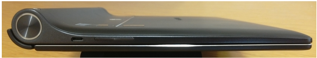
Abbildung 23: Lenovo Yoga 2-1051F zusammengeklappt mit Tastatur von Lenovo, im Lieferumfang enthalten, linke Seitenansicht, von links nach rechts: Power-Button, mikro-USB, Lautstärkewippe
