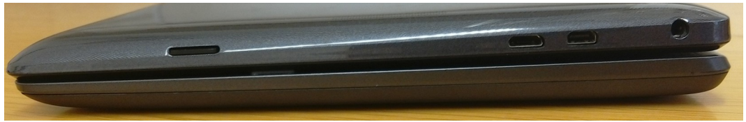
Abbildung 3: Asus Transformer T100TA-DK002H zusammengeklappt rechte Seitenansicht, von links nach rechts: SD-Kartenslot, mini-USB, mikro-HDMI, 3,5mm Klinke
