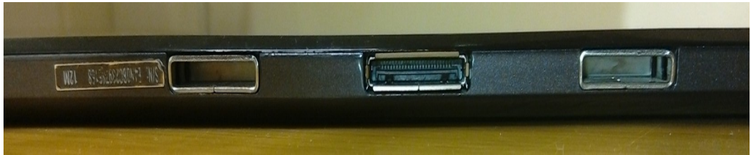
Abbildung 39: Tastaturanschluss Asus Transformer T100TA-DK002H, rechts und links Vertiefungen zur Befestigung an Tastatur
