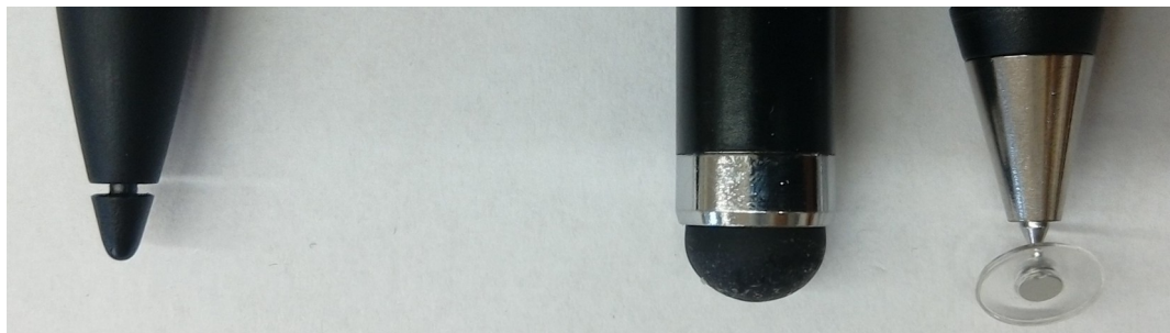
Abbildung 77: Nahaufnahme der Spitzen verschiedener Eingabestifte von links nach rechts: Dell Aktiv Stylus PR77S, Hama Soft Touch, Adonite Jot Pro
