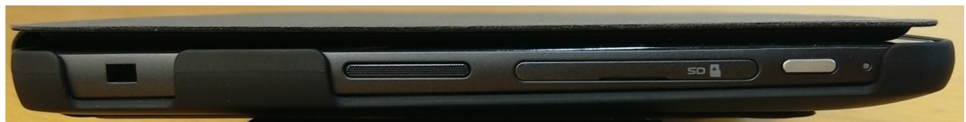
Abbildung 15: Dell Venue 11 Pro 7140-T07G mit Tastaturhülle vom Hersteller, linke Seite, von links nach rechts: Befestigungsmöglichkeit zur Sicherung des Tablet-PC, Lautsprecher, SD-Kartenslot, Power-Button
