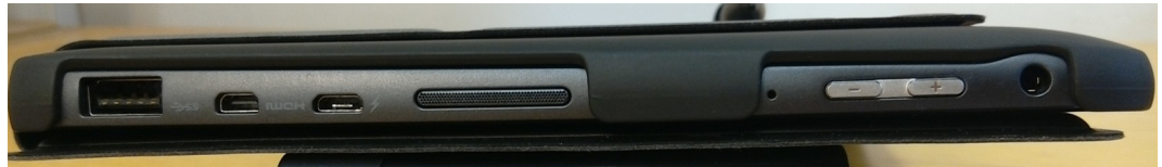
Abbildung 14: Dell Venue 11 Pro 7140-T07G mit Tastaturhülle vom Hersteller, rechte Seite, von links nach rechts: USB, micro-HDMI, micro-USB, Lautsprecher, Mikrofon, Lautstärkewippe, 3,5mm Klinke
