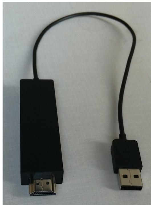
Abbildung 58: Microsoft Wireless Display Adapter von links nach rechts: HDMI, USB zur Stromversorgung
