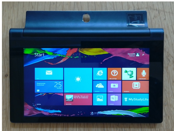
Abbildung 21: Lenovo Yoga 2-851F klappt man den Standfuß um 180° aus, lässt sich das Gerät aufhängen
