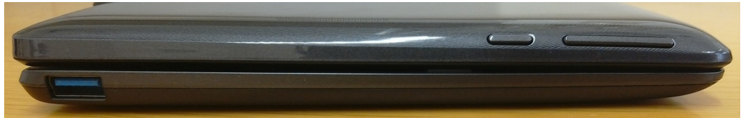
Abbildung 4: Asus Transformer T100TA-DK002H zusammengeklappt linke Seitenansicht, von links nach rechts: USB 3.0 im Tastaturdock, Windows-Taste, Lautstärkewippe
