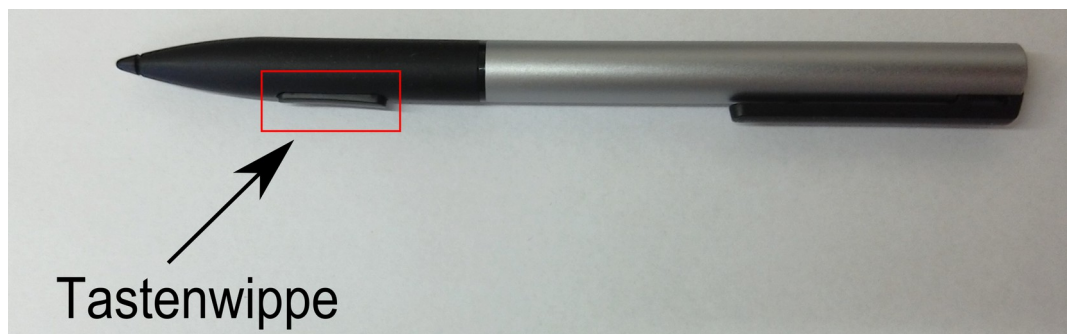
Abbildung 75: Aktiver Eingabestift: Dell Aktiv Stylus PR77S, über die Tastenwippe können zwei Aktionen gewählt werden: Radieren und auswählen
