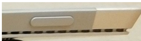
Abbildung 29: Microsoft Surface 3 Pro, Ansicht von oben, Power-Button
