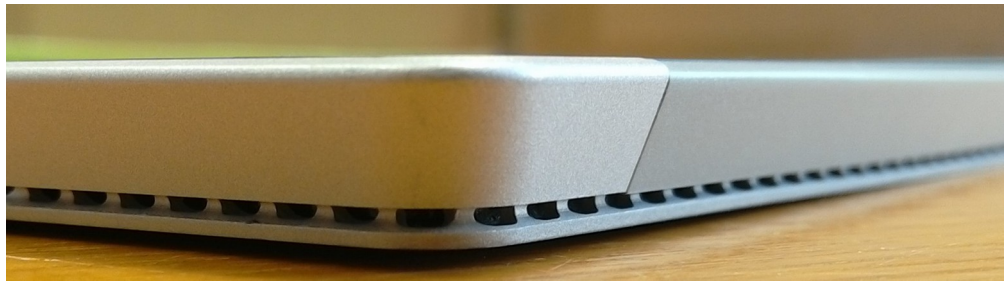
Abbildung 53: Lüftungsschlitze am Microsoft Surface 3 Pro
